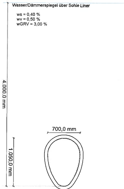
Die Gelenkringverformung wird analog A 143-2 als eine Erhöhung ( $w_{grv}/10$ ) der eingegebenen örtlichen Verformung angesetzt.
