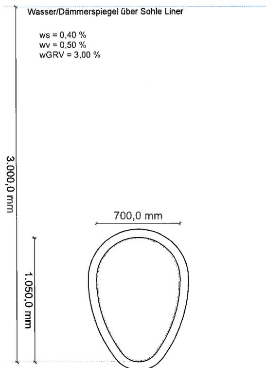
Die Gelenkringverformung wird analog A 143-2 als eine Erhöhung ( $w_{GRV}/10$ ) der eingegebenen örtlichen Verformung angesetzt.
