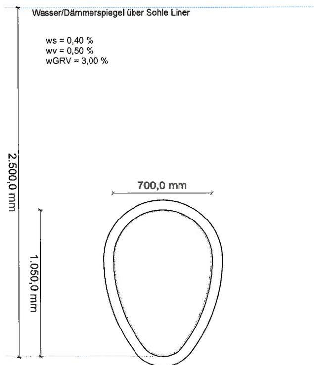
Die Gelenkringverformung wird analog A 143-2 als eine Erhöhung ( $w_{GRV}/10$ ) der eingegebenen örtlichen Verformung angesetzt.
