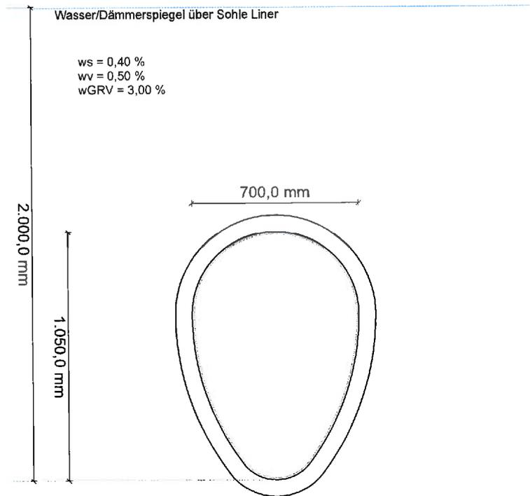
Die Gelenkringverformung wird analog A 143-2 als eine Erhöhung ( $w_{GRV}/10$ ) der eingegebenen örtlichen Verformung angesetzt.
