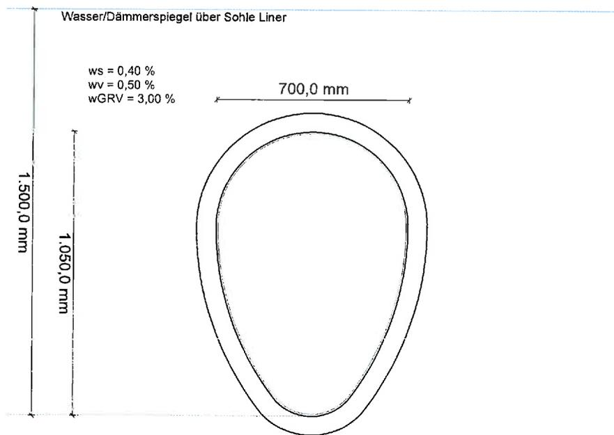
Die Gelenkringverformung wird analog A 143-2 als eine Erhöhung ( $w_{grv}/10$ ) der eingegebenen örtlichen Verformung angesetzt.
