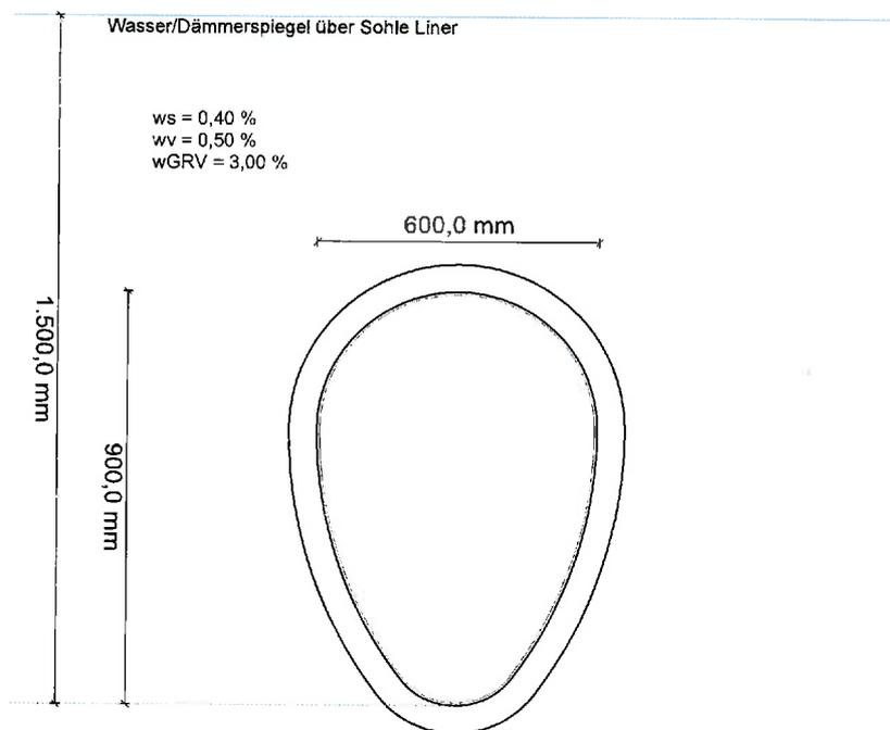
Die Gelenkringverformung wird analog A 143-2 als eine Erhöhung ( $w_{grv}/10$ ) der eingegebenen örtlichen Verformung angesetzt.
