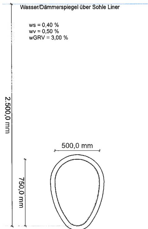
Die Gelenkringverformung wird analog A 143-2 als eine Erhöhung ( $w_{GRV}/10$ ) der eingegebenen örtlichen Verformung angesetzt.
