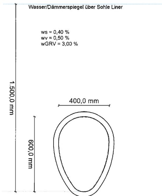
Die Gelenkringverformung wird analog A 143-2 als eine Erhöhung ( $w_{GRV}/10$ ) der eingegebenen örtlichen Verformung angesetzt.
