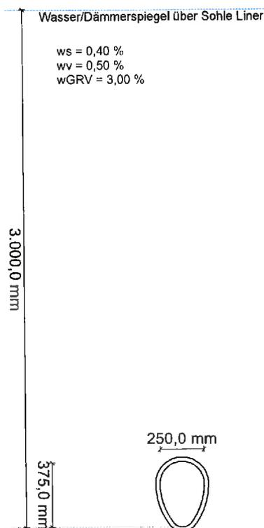
Die Gelenkringverformung wird analog A 143-2 als eine Erhöhung ( $w_{GRV}/10$ ) der eingegebenen örtlichen Verformung angesetzt.
